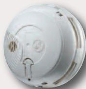
Il détecte l'opacité de l'air ambiant et prévient les occupants par sa propre sonnerie (85db) mais envoie également un signal à la centrale du système d'alarme pour :
