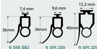
Le profil caoutchouc reçoit les cellules optiques.
