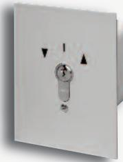
Un contact momentané à la fermeture et contact fixe à l'ouverture. Caractéristiques du contact : tension nominale 230V - Courant maxi 16A sous 230V. Montage scellé sans boîtier d'encastrement. Barillet européen. Livré avec 3 clés.
