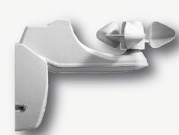
Capteur filaire vent (articulé). Raccordement 2 fils. Câble 3 mètres. IP34. **Dimensions : 160 x 236 x 115 mm.**
