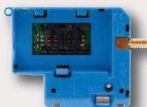
Le module de transmission GSM est placé à l'intérieur de la Centrale Protexial io et permet la transmission d'une alerte en utilisant le réseau de **téléphonie mobile**.
