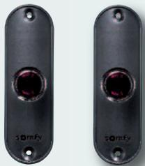
Montées en saillie sur chaque pilier du portail ou disposées de part et d'autre d'une porte de garage, un faisceau infrarouge invisible (portée maxi de 10 m) est envoyé entre la cellule émettrice et la cellule réceptrice. Pour encore plus de sécurité, il est possible de croiser 2 jeux de cellules (un à l'extérieur et un à l'intérieur de la propriété).
