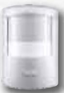
Disposé à l'angle d'une pièce, le détecteur de mouvement infrarouge pour l'habitat avec chien détecte toute présence dans une pièce au delà d'un mètre au dessus du sol. Sa lentille optique spécifique autorise les déplacements de l'animal qui peut rester dans un habitat sous protection. Ce détecteur n'est pas adapté aux animaux tels que chat, oiseau...
