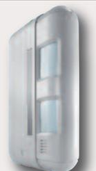
Disposé sur la façade extérieure d'une maison, il assure la protection de l'ensemble des ouvrants de la façade où il est installé (fenêtres, baies, portes ...). Ses 2 faisceaux de détection, réglables indépendamment, doivent être coupés simultanément pour déclencher une alarme, limitant ainsi les faux déclenchements dus aux animaux.
