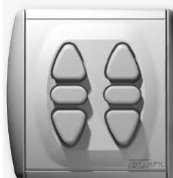
Permet la commande individuelle de 2 stores. 5 positions : 2 positions fixes, 2 positions momentanées pour l'orientation des lames, 1 position repos. Montage encastré dans boîtiers réf. 9128033 - 9128765 - 9660215. Montage apparent dans boîtier réf. 9001244. **Dimensions : 80 x 80 x 27 mm.**
