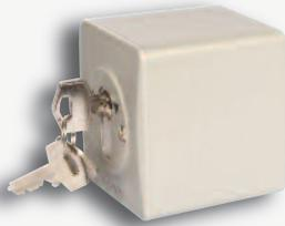
Commande par contact verrouillé des 2 côtés. Caractéristiques du contact : Tension nominale 230V Courant maxi 16A sous 230V. Boîtier laqué en aluminium. Barillet européen. Livré avec 3 clés.
