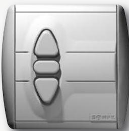
Permet la commande individuelle de 1 store. 5 positions : 2 positions fixes, 2 positions momentanées pour l'orientation des lames, 1 position repos. Montage encastré dans boîtiers réf. 9128033 - 9128765 - 9660215. Montage apparent dans boîtier réf. 9001244. **Dimensions : 80 x 80 x 27 mm.**
