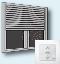
Axe motorisé pour porte-fenêtre d'une largeur de 1000 à 2500 mm. Piloté par une commande murale Smooove tactile io. Portée de 200m en champ libre et 20m à travers deux murs en béton armé. Possibilité de commande de zones ou générale grâce aux autres émetteurs io-homecontrol.
