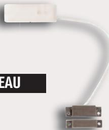
Destiné à un usage intérieur et grâce à un aimant déporté, ce détecteur d'ouverture protège : une menuiserie (porte ou fenêtre) en aluminium, en pvc renforcé ou blindée, une baie coulissante ou une double baie coulissante (à l'aide d'un deuxième aimant).
