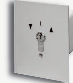
Commande par contact momentané des deux côtés. Caractéristiques du contact : Tension nominale 230V - Courant maxi 16A sous 230V.
