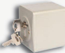
Commande par contact momentané des deux côtés. Caractéristiques du contact : Tension nominale 230V - Courant maxi 16A sous 230V.
