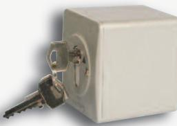
Montage en saillie IP 54 dans une boîte de ø 62. Commande par impulsion d'un seul côté. Ouverture-retour à 0. La clé ne peut être retirée qu'en position 0. Courant maxi : x10 A sous 230 V. Livré avec 3 clés.
