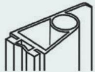
Livré avec rail acier galvanisé en C + caoutchouc.
