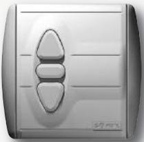
**Commande murale par ligne Bus IB générale.** S'encastre dans les boîtiers standard du marché. Possibilité de montage en saillie sur le boîtier réf. 9000997. Montée, stop, descente, réalisée par 3 boutons indépendants. Applications : habitat et collectif. **Installation en intérieur.** (encasté ou saillie) **Température de fonctionnement** : de 0°C à +40°C. **Dimensions** : 80 x 80 x 24 mm.
