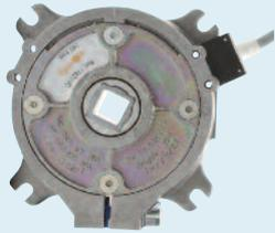
Détecte une brusque accélération dans le sens de la descente de la porte, causée par une rupture accidentelle d'un des éléments de connexion entre la transmission et l'arbre de la porte. En cas de déclenchement de l'antichute, un dispositif de sécurité coupe automatiquement l'alimentation électrique du moteur
