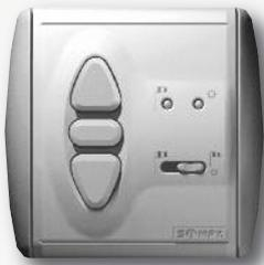
Commande murale par ligne Bus IB vent/soleil. Permet la commande de plusieurs opérateurs en utilisant les commandes individuelles CENTRALIS UNO IB. Sélecteur du mode soleil + protection vent ou du mode protection vent seul. Compatible avec Centralis UNO IB et Smooove UNO IB Mode démonstration.
