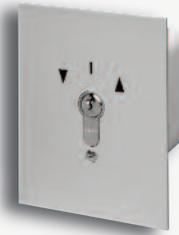
Commande par contact verrouillé des 2 côtés. Caractéristiques du contact : Tension nominale 230V - Courant maxi 16A sous 230V. Boîtier laqué en aluminium. Barillet européen. Livré avec 3 clés.
