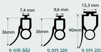
Le profil caoutchouc reçoit les cellules optiques.
