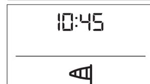
Lorsque la Fonction Vent est momentanément active (seuil dépassé), les équipements se déplacent immédiatement vers la position de fin de course haute, et le symbole de vent et la flèche MONTÉE s'affichent durant le déplacement.
