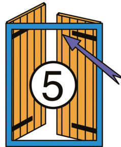
Montage du linteau Retard gauche Sortie droite du câble.
