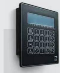
Les claviers capacitifs 001STLCDNF et 001STLCDFB sont des dispositifs de nouvelle conception. Leurs touches à effleurtement ergonomiques simplifient les opérations de contrôle du système anti-intrusion.
