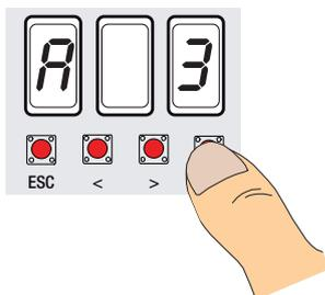
Sélectionner 1 et appuyer sur ENTER pour confirmer l'opération de réglage automatique de la course.
