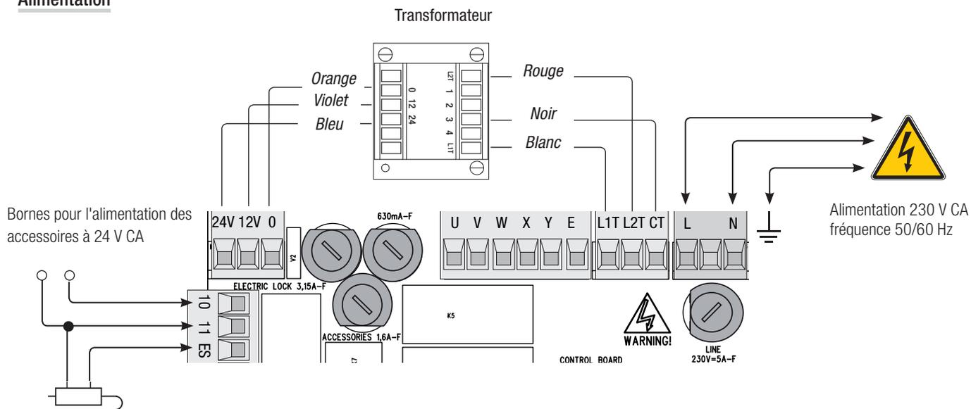
Serrure de verrouillage électrique 12 V - 15 W max.
