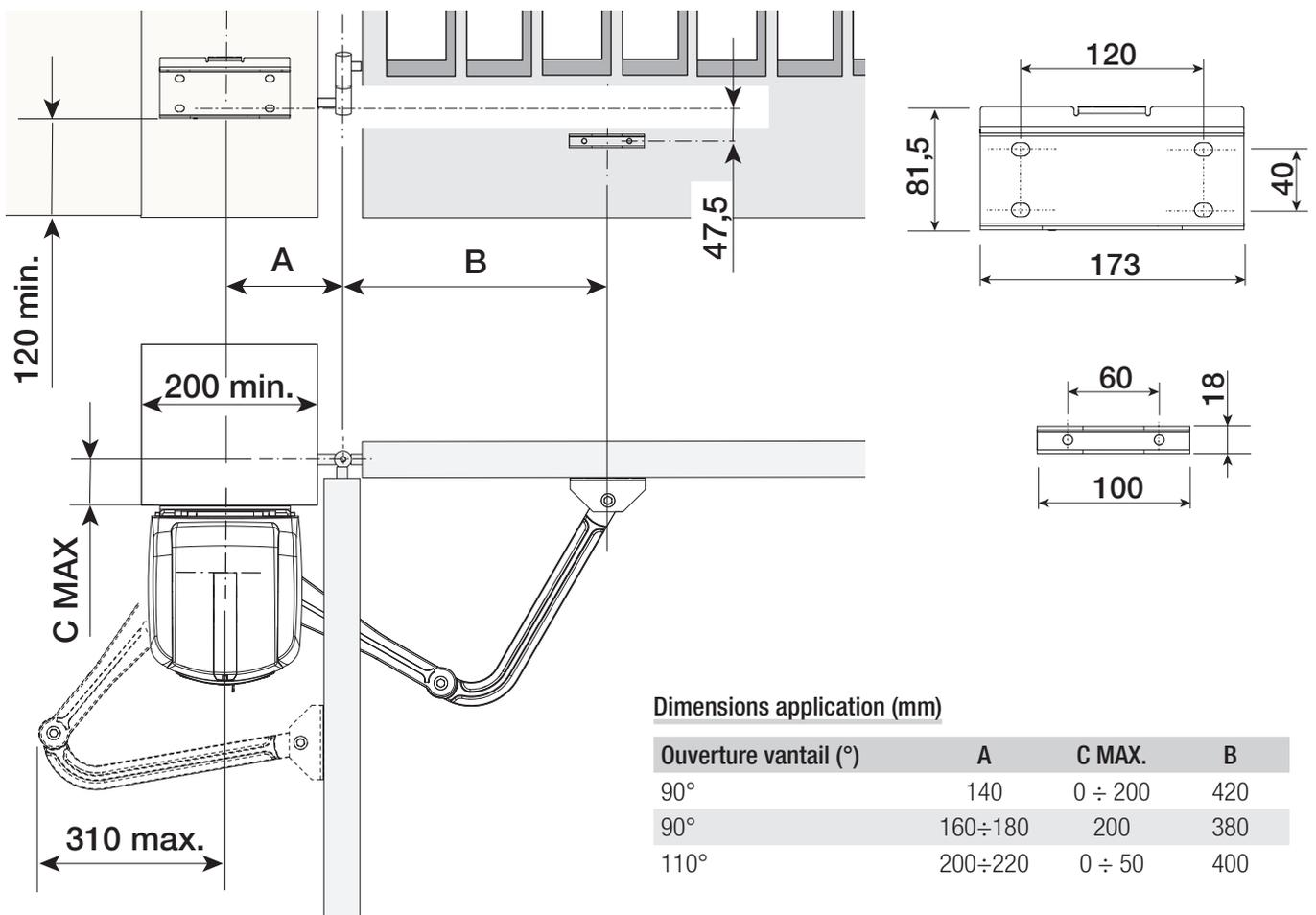
Noter les points de fixation de l'étrier pilier et de l'étrier portail. Les cotes d'entraxe des trous des étriers sont indiquées au paragraphe dimensions.
