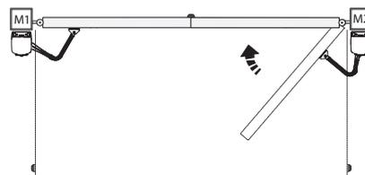
...le vantail du deuxième motoréducteur, effectuera ensuite une manœuvre d'ouverture jusqu'à la butée d'arrêt...
