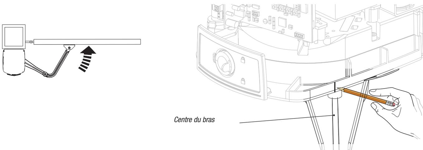
Ouvrir manuellement le vantail. Introduire la butée mécanique comme indiqué.
