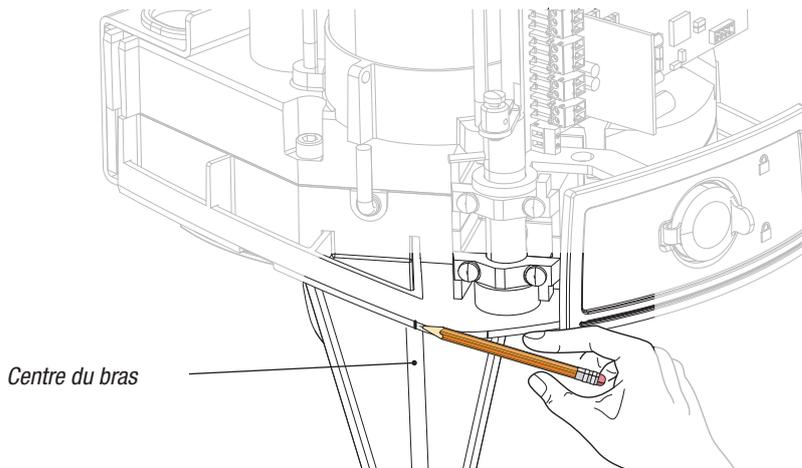
Fermer manuellement le vantail. Introduire la butée mécanique comme indiqué. Le signe sur le boîtier doit correspondre à la rainure présente sur la butée.
