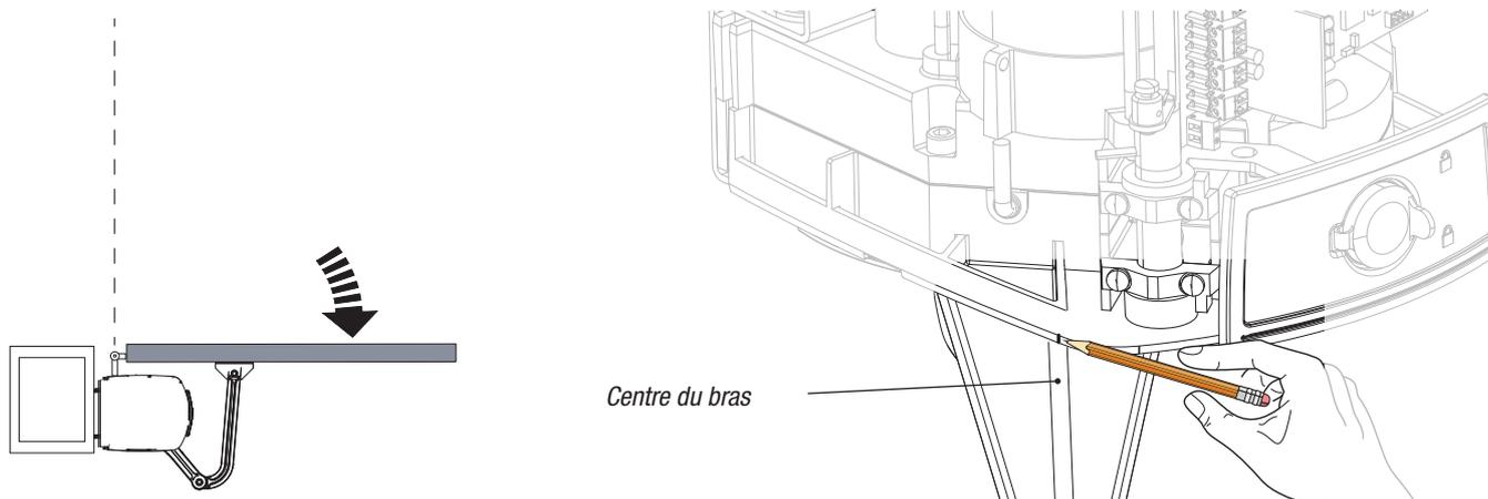
Ouvrir manuellement le vantail. Introduire la butée mécanique comme indiqué.
