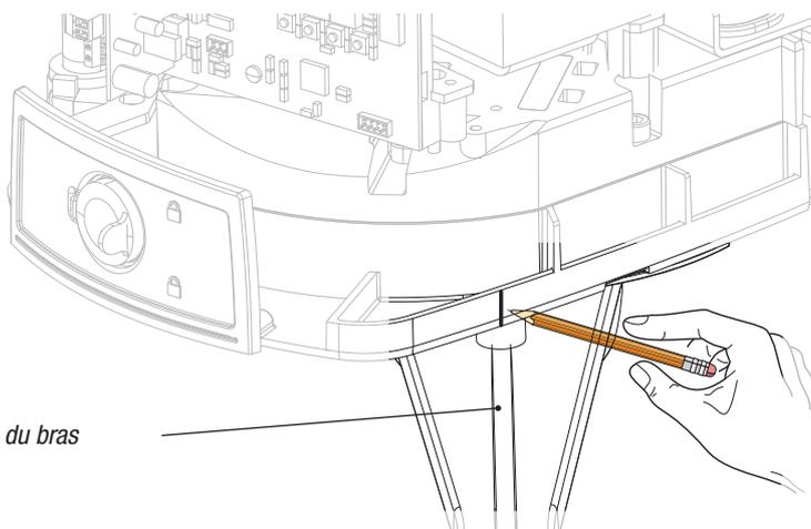
Fermer manuellement le vantail. Introduire la butée mécanique comme indiqué. Le signe sur le boîtier doit correspondre à la rainure présente sur la butée.
