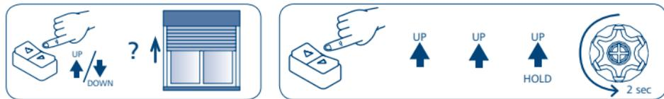
À l'aide du bouton de descente, fermer complètement le volet en laissant le moteur détecter automatiquement le fin de course.
