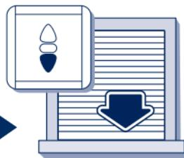
Depuis la position de fins de course haute désirée, descendre le volet. Appuyer sur le bouton descente et laisser le moteur s'arrêter de lui-même.
