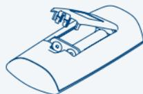
Skipper LCD fonctionne avec 2 piles alcalines de 1.5 V format LR03 (AAA). Le changement des piles usées s'effectue seulement avec des piles ayant les mêmes caractéristiques. Les piles usagées doivent être déposées dans des containers prévus à cet effet et de toute façon conformément aux lois en vigueur.
