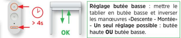
Réglage butée basse : mettre le tablier en butée basse et inverser les manœuvres «Descente - Montée»
