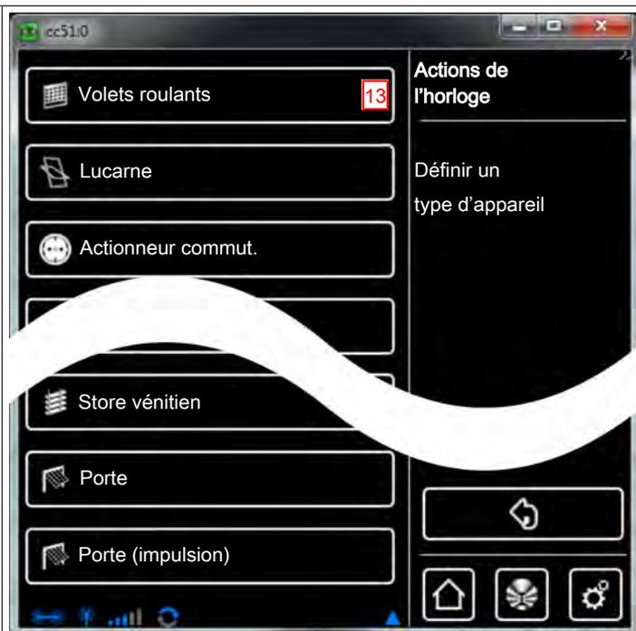
14 Sélectionnez dans la liste l'objet-cible souhaité devant être commandé par l'horloge. Seuls les objets-cibles correspondant au type d'appareil sélectionné précédemment seront affichés.
