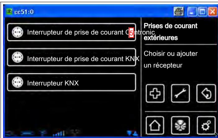
**6** Appuyez sur le bouton « - » pour supprimer le récepteur sélectionné et revenir automatiquement sur l'affichage de la liste des récepteurs.
