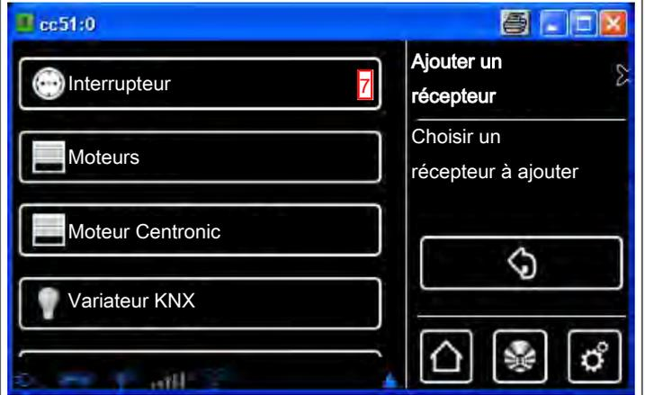
8 Le récepteur (interrupteur) sélectionné est maintenant affecté à la pièce (chambre) et apparaît dans la liste des récepteurs contenus dans cette pièce.
