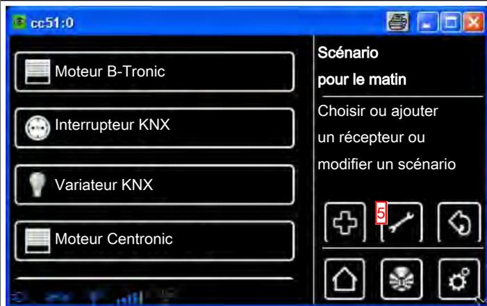
6 Vous pouvez maintenant modifier tous les réglages disponibles du récepteur sélectionné (dans l'exemple un moteur B-Tronic / KNX).
