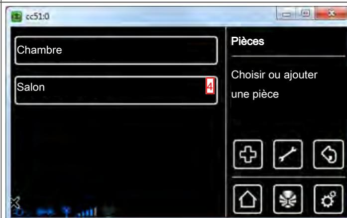
**5** Tous les récepteurs affectés à la pièce sont affichés dans la liste des récepteurs sur l'écran suivant. Dans l'exemple, seul un récepteur portant le nom « Interrupteur » est affecté à la pièce. Pour supprimer un récepteur d'une pièce, appuyez sur le récepteur souhaité.
