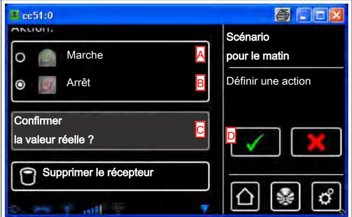
**Possibilité de réglage d'un actionneur de commutation Centronic dans un scénario :**
