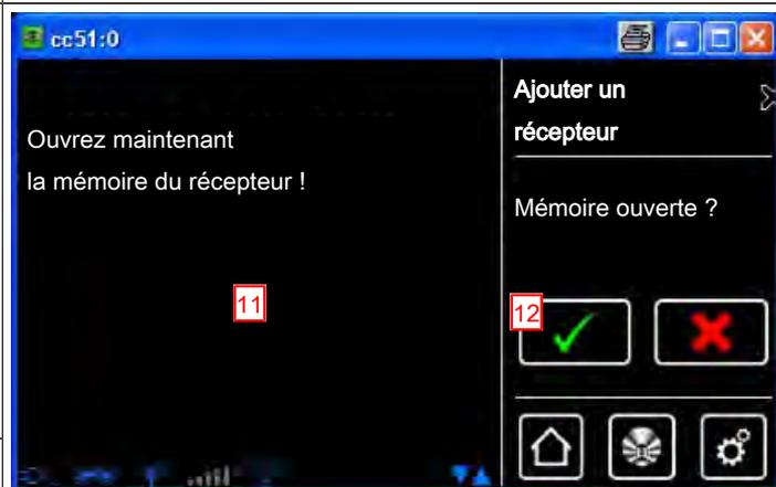
13 Sur l'écran apparaît un message indiquant que le processus de programmation a fonctionné ; en outre, de nombreux récepteurs confirment également le succès du processus. Dans le cas des moteurs, un bruit de claquement est souvent perceptible ou la LED d'état du récepteur clignote. Consultez le manuel du récepteur correspondant pour savoir si (et si oui, comment) le récepteur que vous souhaitez programmer transmet un retour.
