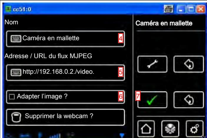
**6** L'affichage est optimisé pour une résolution de 320 x 240 (QVGA) pixels. Si l'image de la caméra n'est affichée que partiellement ou fortement réduite, modifiez le réglage correspondant sur votre caméra. Si cela est impossible, activez l'option « Adapter l'image » Notez que lorsque les formats de sortie des images varient fortement, l'affichage peut être plus lent.
