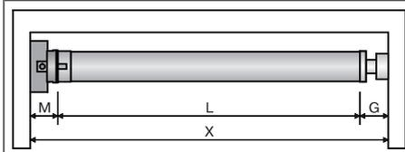
Déterminez l'encombrement latéral (M) en mesurant la tête du moteur et le support mural. Pour obtenir la longueur (L) de l'axe, soustrayez l'encombrement latéral (M) et l'embout (G) à la dimension intérieure du coffre (X) :  $L=X-M-G$ .
