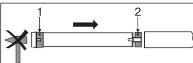
Montez le moteur tubulaire avec la couronne correspondante (1) et la roue (2). Insérez le moteur tubulaire dans l'axe, avec la couronne et la roue prémontées. Veillez à ce que la couronne et la roue soient correctement logées dans l'axe.
