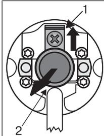
Le tenon (2) s'enclenche automatiquement lors de son insertion. Pour démonter le tenon (2), poussez la plaque de sécurité (1) vers le haut et retirez le tenon (2).
