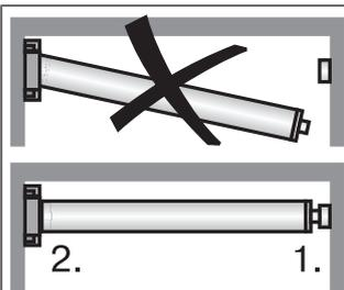
Accrochez l'unité montée (axe, moteur tubulaire et embout) dans le coffre de la manière suivante.
