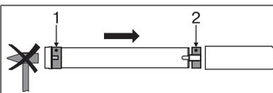
Montez le moteur tubulaire avec la couronne correspondante (1) et la roue (2). Insérez le moteur tubulaire dans l'axe, avec la couronne et la roue prémontées. Veillez à ce que la couronne et la roue soient correctement logées dans l'axe.
