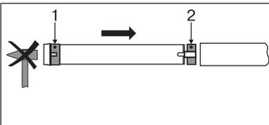
Montez le moteur tubulaire avec la bague correspondante (1) et la roue (2). Si la bague dispose de plusieurs rainures, choisissez la rainure parfaitement appropriée et faites glisser la bague (1) sur la couronne.
