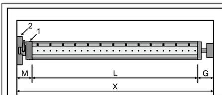
Déterminez l'encombrement latéral (M) en mesurant la tête du moteur (1) et le support mural (2). Pour obtenir la longueur (L) de l'axe, soustrayez l'encombrement latéral (M) et l'embout (G) à la dimension intérieure du coffre (X) :  $L = X - M - G$ .
