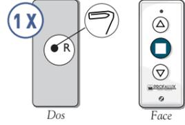
a) Avec la télécommande appartenant au réseau, à l'aide d'un trombone, appuyer 1 fois sur R au dos de la télécommande, puis sur le bouton Stop
