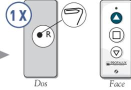
Prendre la télécommande d'un volet, à l'aide d'un trombone appuyer 1 fois sur R au dos de la télécommande, puis sur le bouton Montée
