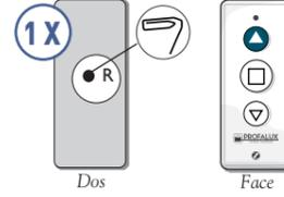
b) Avec la télécommande du volet à ajouter, à l'aide d'un trombone, appuyer 1 fois sur R au dos de la télécommande, puis sur le bouton Montée
