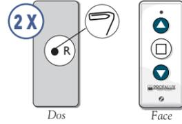
Avec la télécommande d'un volet du réseau, à l'aide d'un trombone, appuyer 2 fois sur R au dos de la télécommande, puis simultanément sur les boutons Montée et Descente
