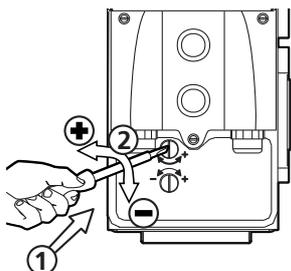
Repérer la vis contrôlant le sens de rotation "montée" et celle contrôlant le sens descente; sens 1 ou sens 2. Des flèches positionnées autour de l'arbre creux indiquent également le sens de rotation. Si le moteur ne tourne pas dans le sens désiré, inverser S1 et S2. Lorsque le moteur est arrêté après un ordre de commande, enfoncer avec un tournevis la vis de réglage correspondant au sens choisi (sens 1 ou sens 2):
