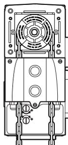
2. Mise en place du guide-chaîne (réf. : 9550114) et de la chaîne (réf. : 9146501).
