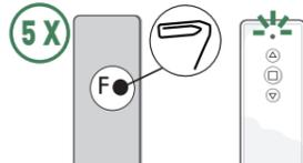
b) A l'aide d'un trombone, appuyer 5 fois sur **F**, au dos de la télécommande, et vérifier lors de chaque appui que le voyant s'allume
