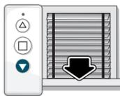
a) Appuyer sur le bouton **Descente** et stopper le BSO à la position basse désirée.
