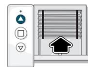
c) Appuyer sur le bouton **Montée** et laisser le BSO s'arrêter de lui-même
