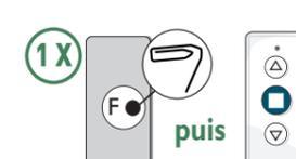
A l'aide d'un trombone, appuyer 1 fois sur **F** au dos de la télécommande puis sur le bouton **Stop**
