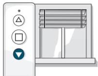
a) Descendre le BSO à l'aide de la télécommande et laisser 4 lames apparentes
