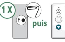
b) A l'aide d'un trombone, appuyer 1 fois sur **F** au dos de la télécommande puis sur le bouton **Descente**.
