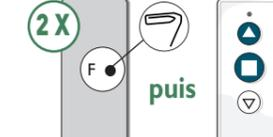
Prendre la télécommande du BSO. A l'aide d'un trombone, appuyer 2 fois sur **F** au dos de la télécommande, puis en même temps sur les boutons **Stop** et **Montée**
