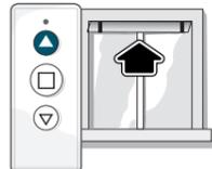
b) Appuyer sur le bouton **Montée** et laisser le BSO s'arrêter de lui-même
