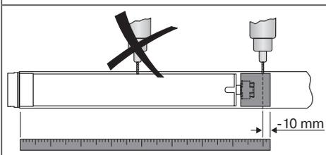
Nous recommandons, pour garantir une transmission sûre du couple de rotation avec des axes ronds, de visser la roue sur l'axe (voir tableau ci-dessous).
