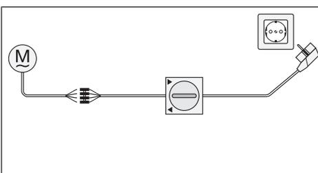
La mise en service peut avoir lieu soit avec le câble avec inverseur (réf. 4901 001 158 0) soit avec l'élément de commande prévu.
