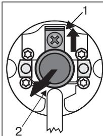
Le tenon (2) s'enclenche automatiquement lors de son insertion. Pour démonter le tenon (2), poussez la plaque de sécurité (1) vers le haut et retirez le tenon (2).
