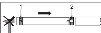
Montez le moteur tubulaire avec la bague correspondante (1) et la roue (2). Si la bague dispose de plusieurs rainures, choisissez la rainure parfaitement appropriée et faites glisser la bague (1) sur la couronne.
