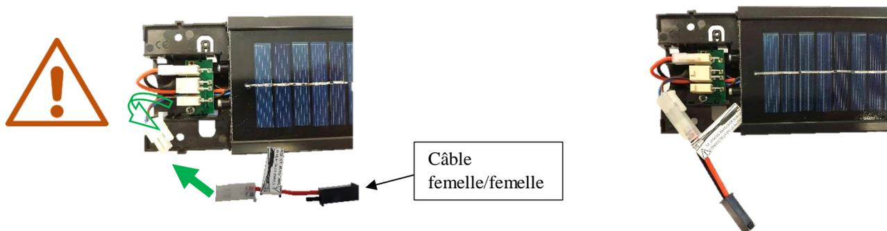
21. Débrancher la batterie et retirer la carte électronique
